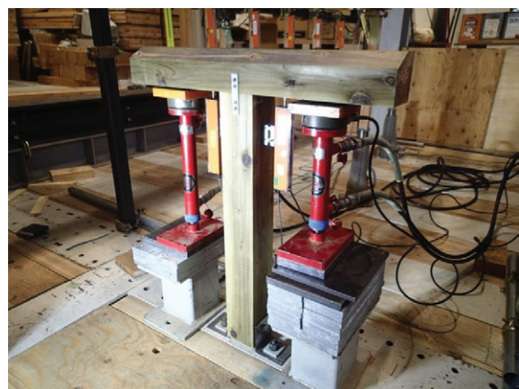
図 4 柱-梁接合部の強度試験
