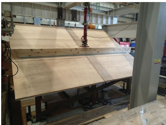
図 1 積雪荷重を想定した載荷試験
