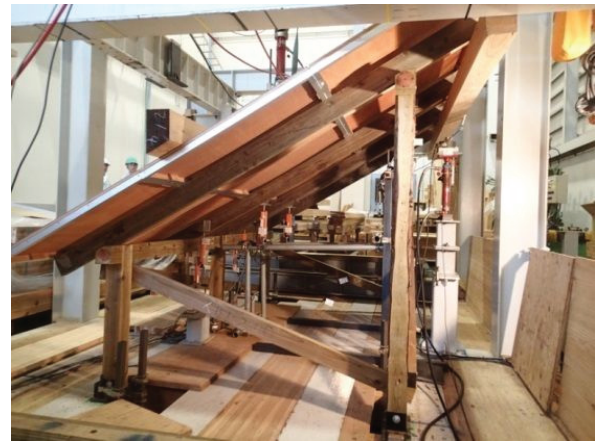
図 2 風荷重を想定した載荷試験
