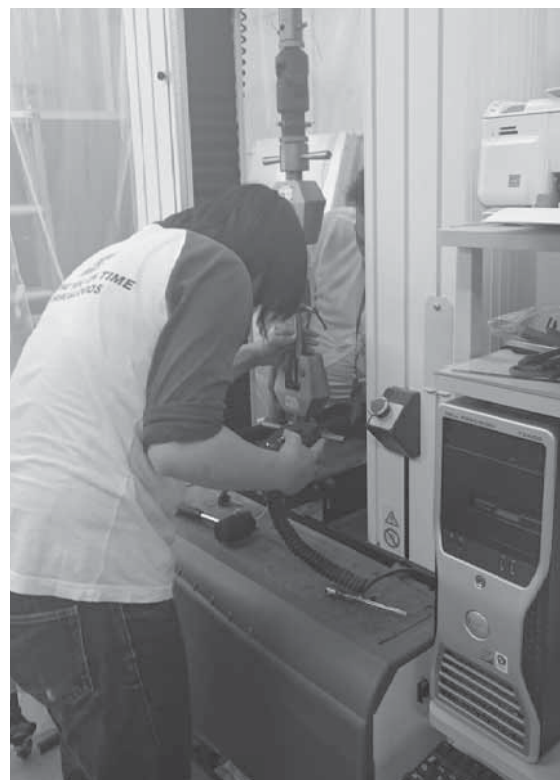
図1. 炭素鋼丸棒試験片を試験装置に取り付けている様子。
