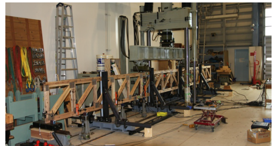
図3 トラス梁部材の曲げ強度試験の様子
