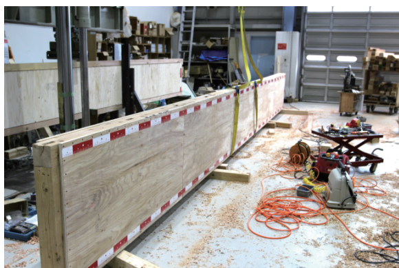
図 8 完成した A タイプ梁部材試験体
