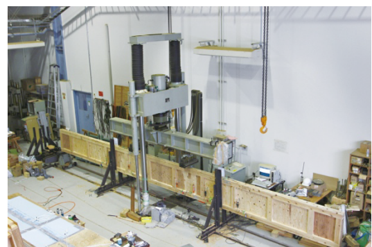
図16 現場接着型 I 型梁部材 曲げ強度試験の様子
