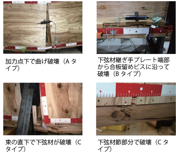
図 13 各タイプの代表的な破壊形態
