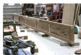
⑥ 完成した B タイプ梁部材試験体
