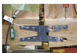
下弦材継ぎ手部 ホールダウンプレートの破断 (606(9)-1)
