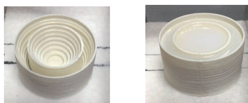
図5 3D プリンタで作製した凹レンズ形状の容器および溝部分に液晶材料を満たした後の様子
