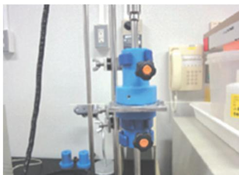
図1 乾麺の透過型近赤外スペクトル測定システム
