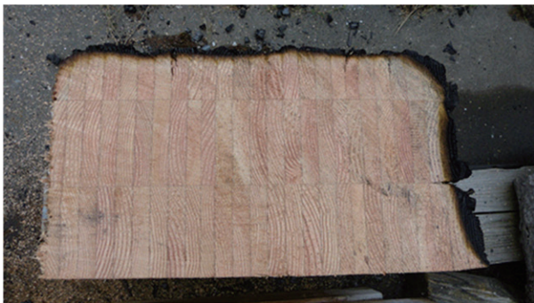
図 3 ベイマツ集成材のみの 1 時間耐火試験における炭化の様子
