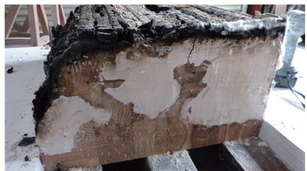
図 6 スギ集成材+ベイマツ集成材の 1 時間耐火試験における炭化の様子
