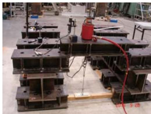
参考図1 固定金物取付部分強度確認試験 (引張).
