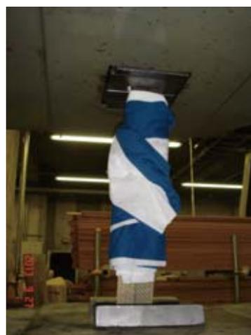
参考図3 留め具部分強度確認試験 (冷却時).
