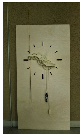
図7 製作した機械式時計
