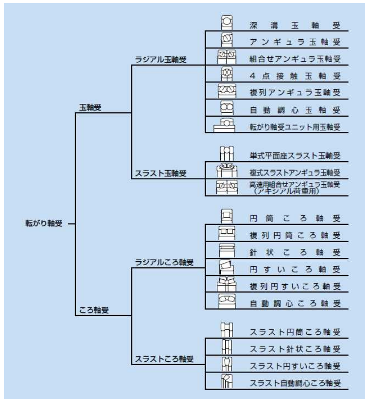
図2 ベアリングの分類 (NTN ハンドブック [1] から引用)
