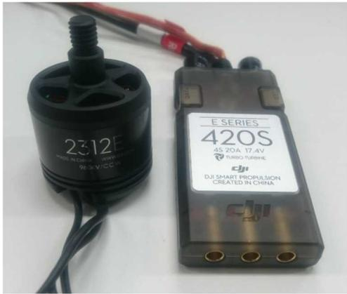
図4 DJI E310 のモータと ESC
