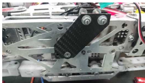
図1. 炭素繊維部材へ変更した部分
