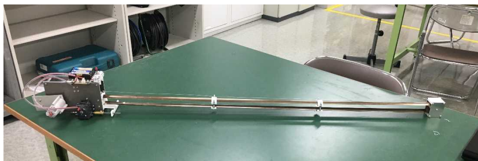
図3 小型伸縮腕 最大伸長状態
