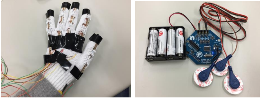
図 1. 曲げセンサーを利用したデータグローブと筋電位計測機
