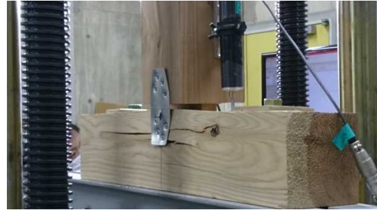
図9 試験の様子（仕口用補強金物）
