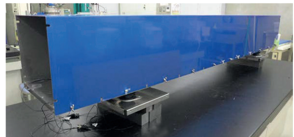
図3 完成した振動測定用角筒状構造体
