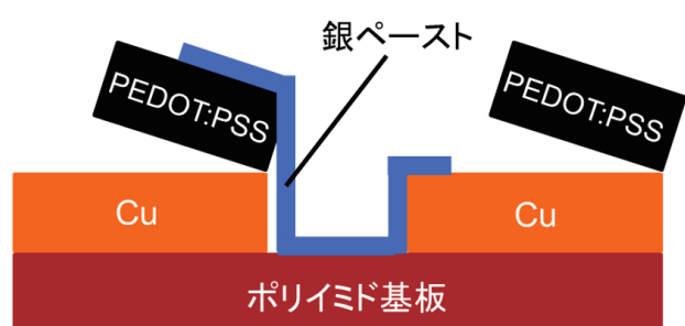
図2 剥離が発生した熱電発電モジュールの断面模式図
