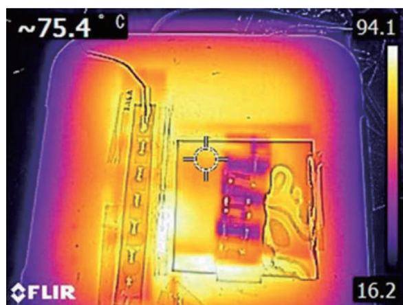
図8 サーモグラフィを用いた各モジュールの温度分布
