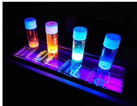
図6 発光材料A, B, C, Dのフォトルミネセンス
