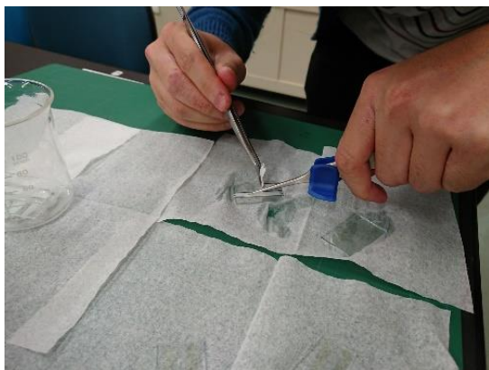
図 1 ビニールテープの剥離
