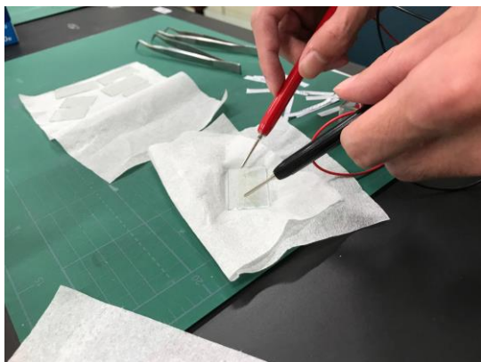
図1 ITO 基板の導通検査の様子
