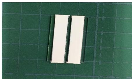
図1 エッチング用のITO基板
