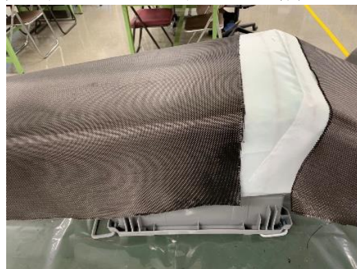
図6.1 製作途中の新キャンノピー（オス型）
